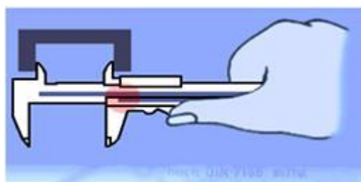
Hình 7: Đo kích thước lỗ bằng thước cặp có mỏ đo trong
